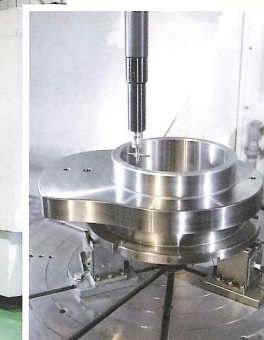
内外研磨機により形状加工
