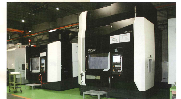
太陽工機 NVG-12T φ1150(テーブル寸法) 最大研削寸法φ1250 最大研削高さ500 積載質量2500kg
